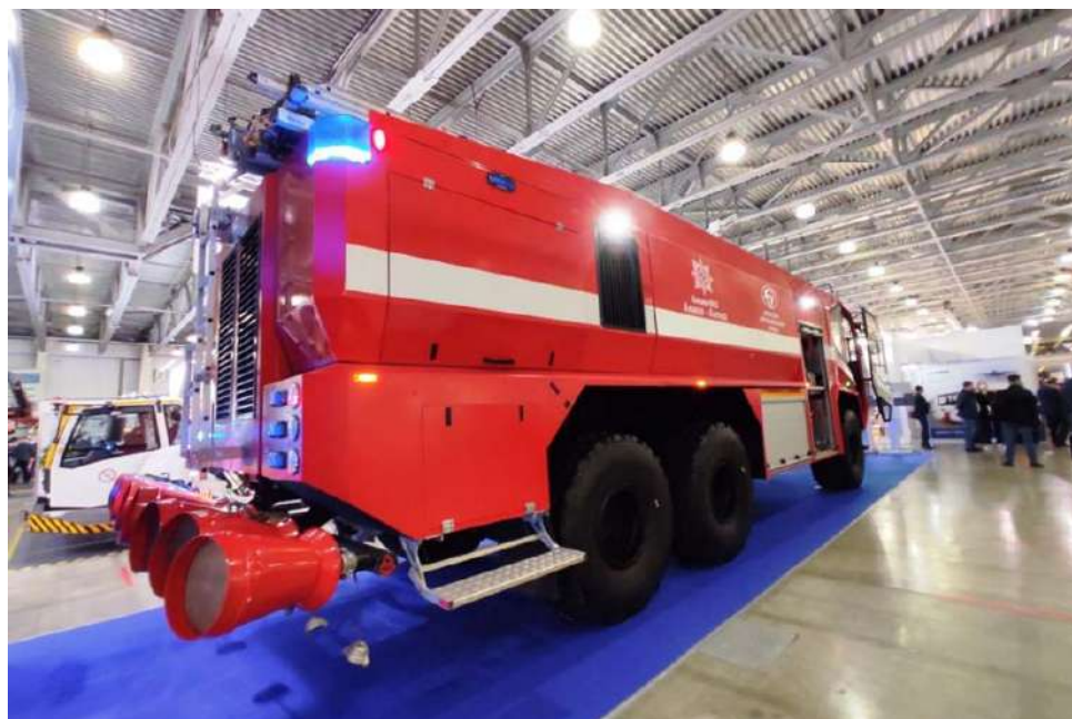
Рис. 6. Комплекс ГПС-600, установленный на заднем бампере ПА
