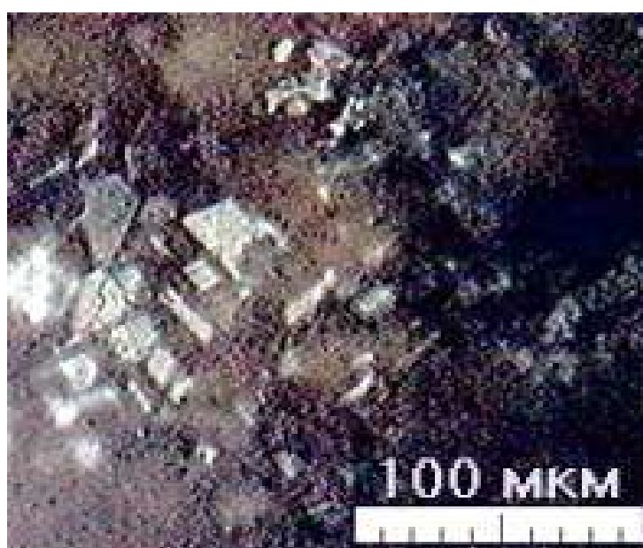
Рис. Микрофотография отложений, образовавшихся на внутренней поверхности резервуара (сторона, прилегающая к металлу) x500
