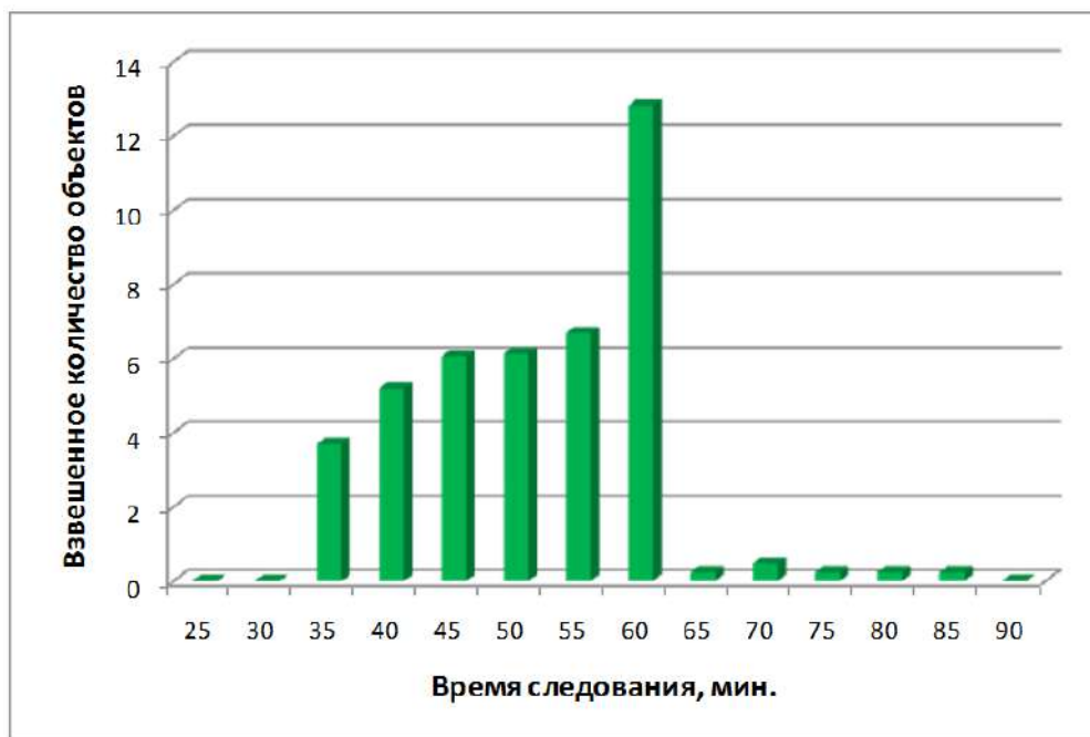
Рис. 2. Распределение количества объектов (точек) в зависимости от времени следования до них от места расположения СПСЧ, взвешенное с весом, равным вероятности возникновения ЧС для данного объекта (точки)
