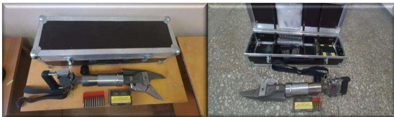
Рис. 2. Комплект поставки пиротехнических ножниц НП-4
