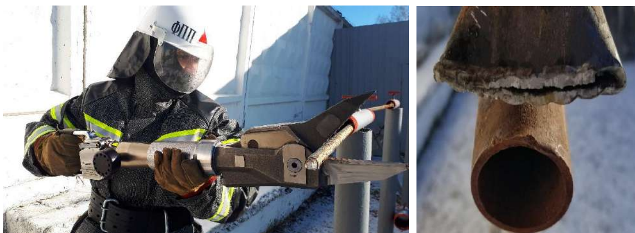
Рис. 3. Рез различных металлоконструкций пиротехническими ножницами НП-4
